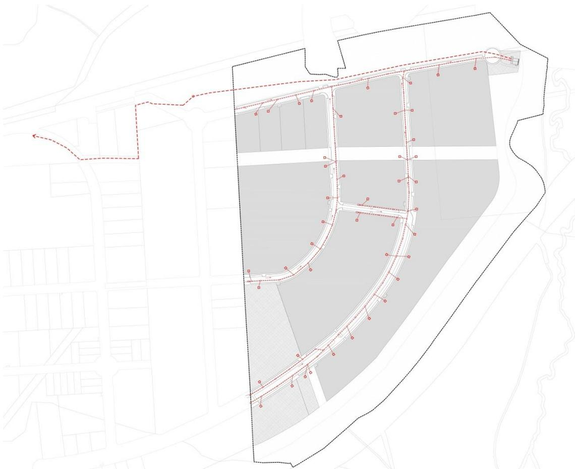
Ilustración 34. Red de saneamiento de aguas fecales propuesta para el Plan Regional y conexión exterior por su extremo noroeste
