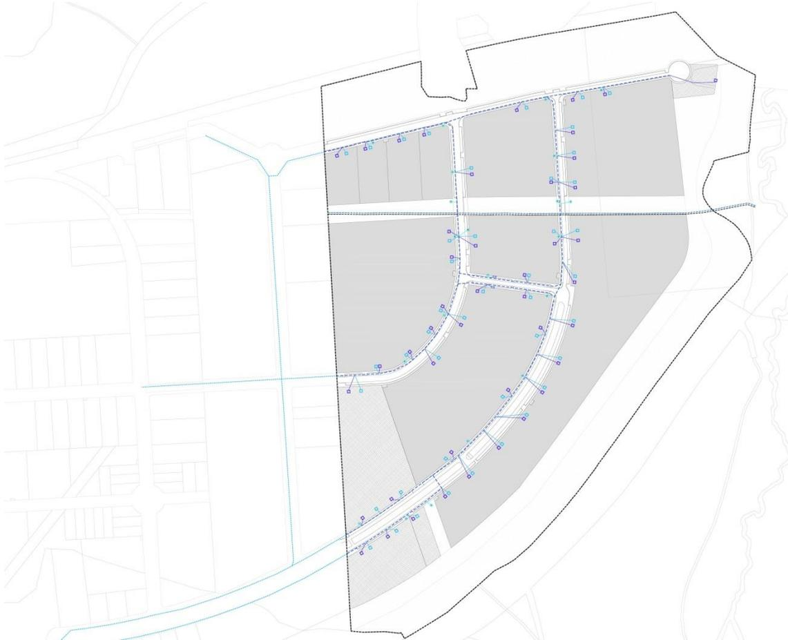
Ilustración 35. Conexión de la red de abastecimiento del Plan Regional a ramales ya existentes de la UA2 del sector.
