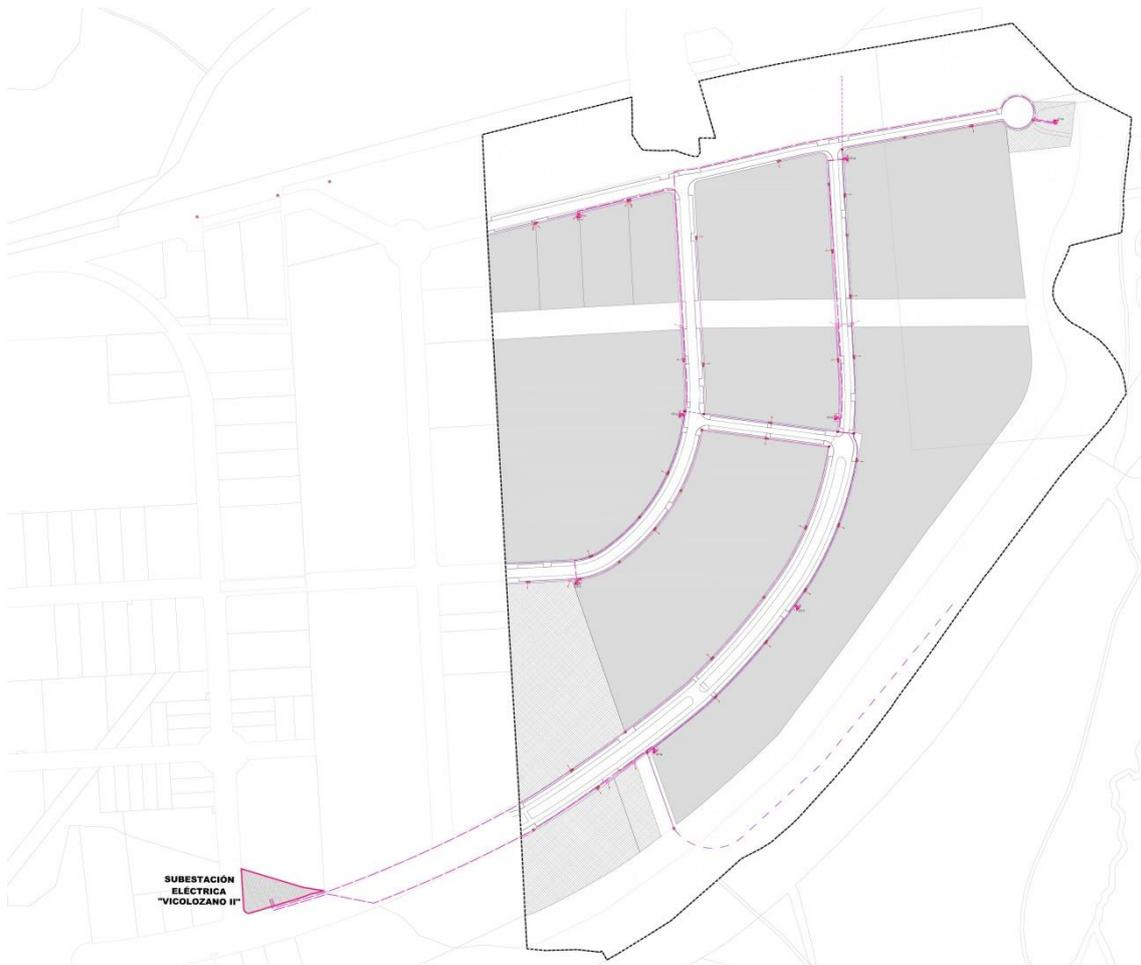
Ilustración 32. Redes de electricidad y telecomunicaciones, y conexión con subestación eléctrica pendiente de ejecución
